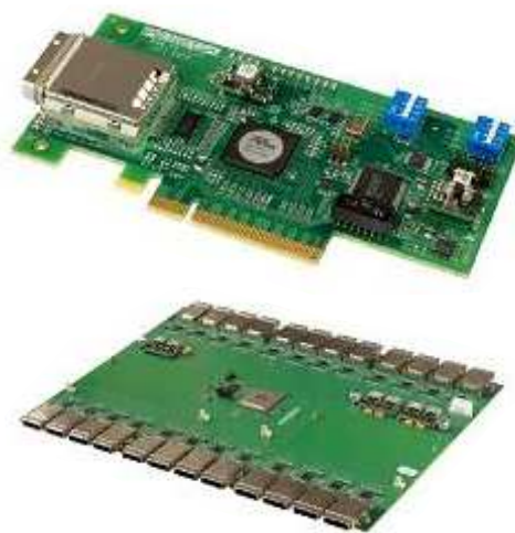
Рис. 2 Интерфейсная плата и плата коммутатора сети МВС-Экспресс
