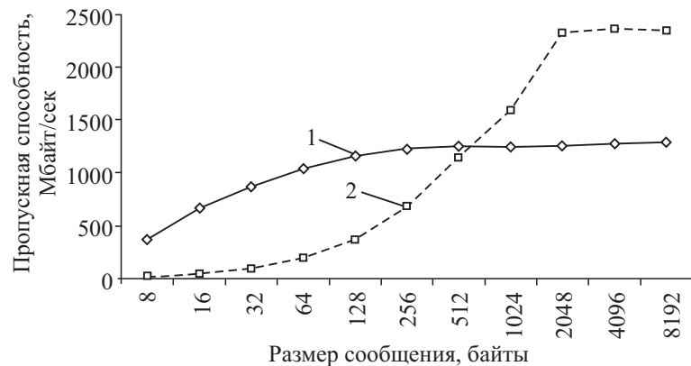
Рис. 5. Пропускная способность на тесте Message Rate, сравнение сетей МВС-Экспресс и InfiniBand Qlogic QDR 4x:
